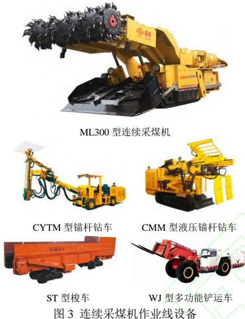
图3 连续采煤机作业线设备
