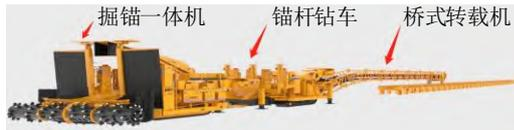
图 23 快速掘锚成套装备
